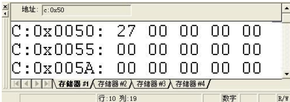
图 1.4 修改后片内 ROM 的 50H 单元中的数值为 27H
