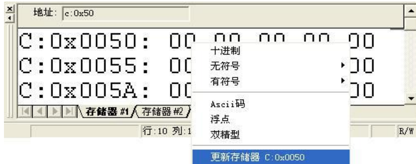
图 1.2 准备修改片内 ROM 的 50H 单元中的数值
