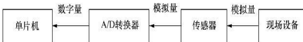
图 7.2 单片机控制 ADC 采集模拟量数据的原理图
